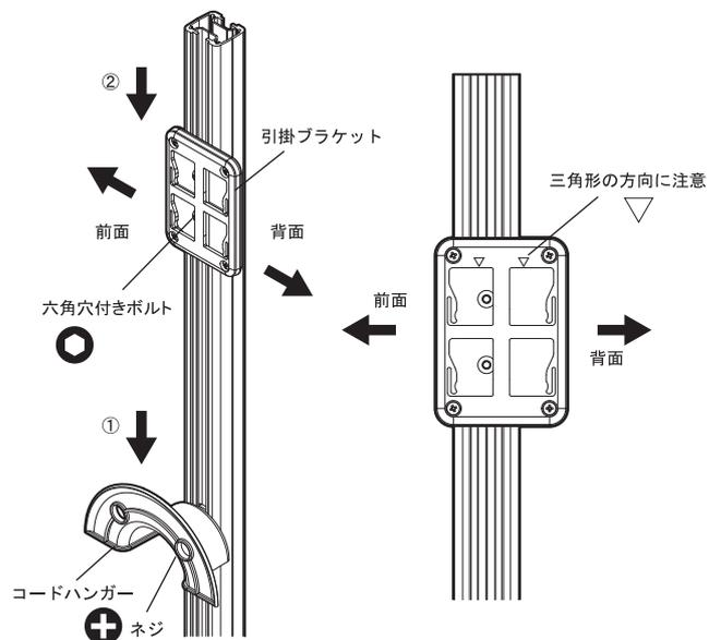
6. 支柱の先端に、固定金具をネジで固定してください。
