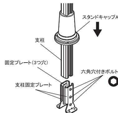
3. 六角穴付きボルトで、支柱固定プレートをスタンドベースに固定してください。固定できたら支柱固定プレートの六角穴付きボルトを、今度もしっかりと固定してください。
