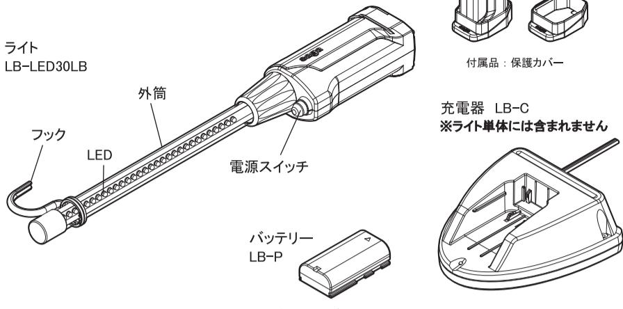
図 1. セット型式（ライト + 充電器 + バッテリー）：LB-LED30LB
