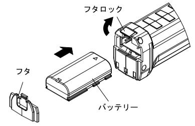
図2. バッテリー差し込み方法
