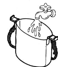
注) 故障の原因となりますので、給水用の水には必ず蒸留水を使用してください。
