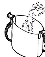
注) 故障の原因となりますので、給水用の水には必ず蒸留水を使用してください。
