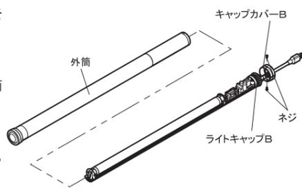
4. 新しい蛍光管を、ピンが垂直になるようにソケットに差込み、90度回転させ、抜けないようにしてください。
