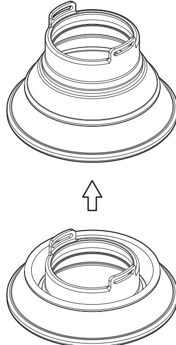
(2) フードの端を引っ張りながら (①)、反対側の端にライトをかけて (②) ゆっくりと挿入する (③) と取り付けやすいです。奥までしっかりと差し込んで取り付けてください。付属の落下防止用のバンドをかけてください。
