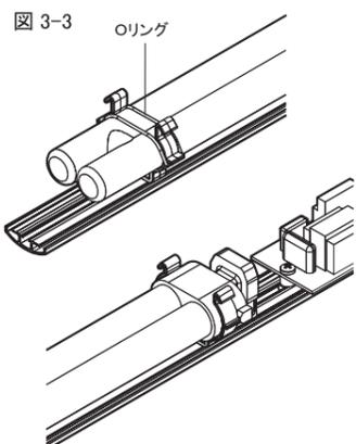
4. 先端側エンドキャップの切り欠き差し込むようにして外筒を被せて、コード側エンドキャップをはめてください。
