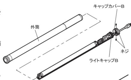
4. 新しい蛍光管を、ピンが垂直になるようにソケットに差し込み、90度回転させ、抜けないようにしてください。
